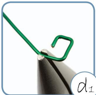
d1- Commencez en faisant un pli à l'une des extrémités du fil à l'aide d'une pince plate. Pliez ensuite régulièrement le fil à angle droit. Assurez-vous de toujours tourner dans le sens déterminé au départ.
